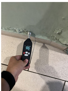
Sókivirágzás a lábazati sávban, 55,5% (WET)
